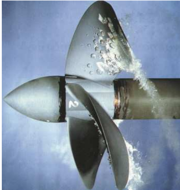
Figura 3: Aparición de burbujas de cavitación en las palas de una hélice.
